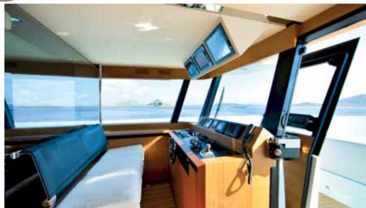
Alla guida la visibilità è ottimale, non solo per le dimensioni delle vetrate, ma anche perché plotter, schermi, computer e display si trovano sulla plancia o sopra la "testa" del timoniere. Un pannello sotto il soffitto, infatti, consente di posizionare due grandi schermi per radar e cartografia.
